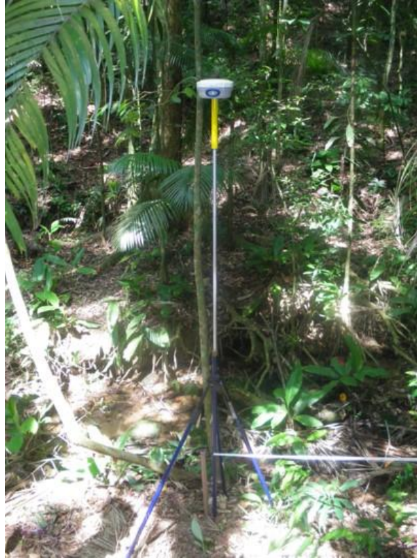
Figura 18: Aparelho GNSS utilizado para georeferenciar as quinas das parcelas levantadas em campo.
