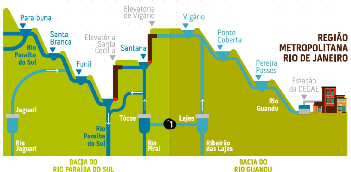
**Figura 2:** Representação esquemática do Sistema Hidráulico do Rio Paraíba do Sul (incluindo a transposição para o Rio Guandu). **Fonte:** ANA (2017, p. 152).
