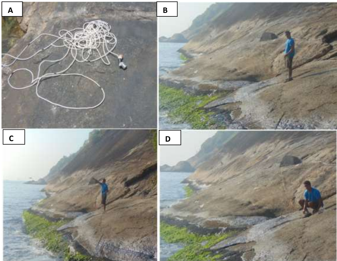
Figura 65: Processo de medição da largura da faixa inferior: A) Cordelete graduado utilizado para mensurar a largura da faixa; B) Posicionamento na extremidade superior da faixa; C) Arremesso do cordelete; D) Nivelamento com o nível do mar para medir a largura da faixa (Fotos: Hannah Olivia).
