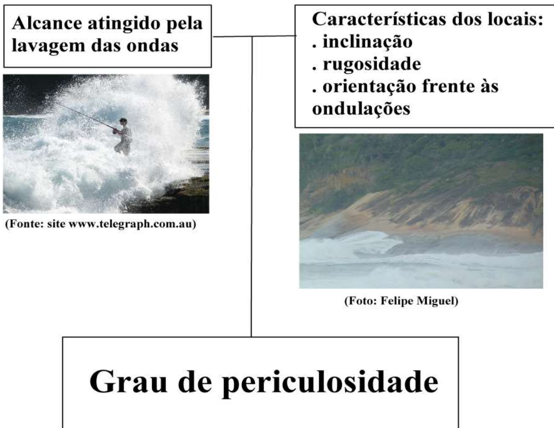
Figura 5: Bases para avaliar o grau de periculosidade dos locais frequentados da costa rochosa do município do Rio de Janeiro, objetivo central do presente estudo.
