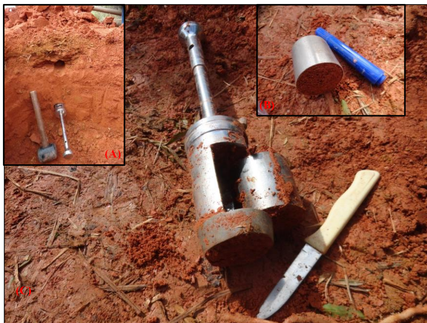
Figura 23. Coleta de amostra volumétrica do solo (A), visto em detalhe no anel de kopeck (A e C). Foto: Leonardo S. Pereira (2016).
