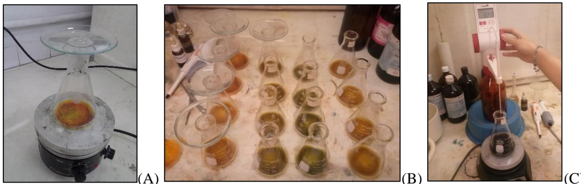
Figura 25. Etapas das análises de matéria orgânica. Aquecendo a solução em placa elétrica (A); soluções em repouso (B); processo de titulação (C). Foto: Leonardo S. Pereira (2017).
