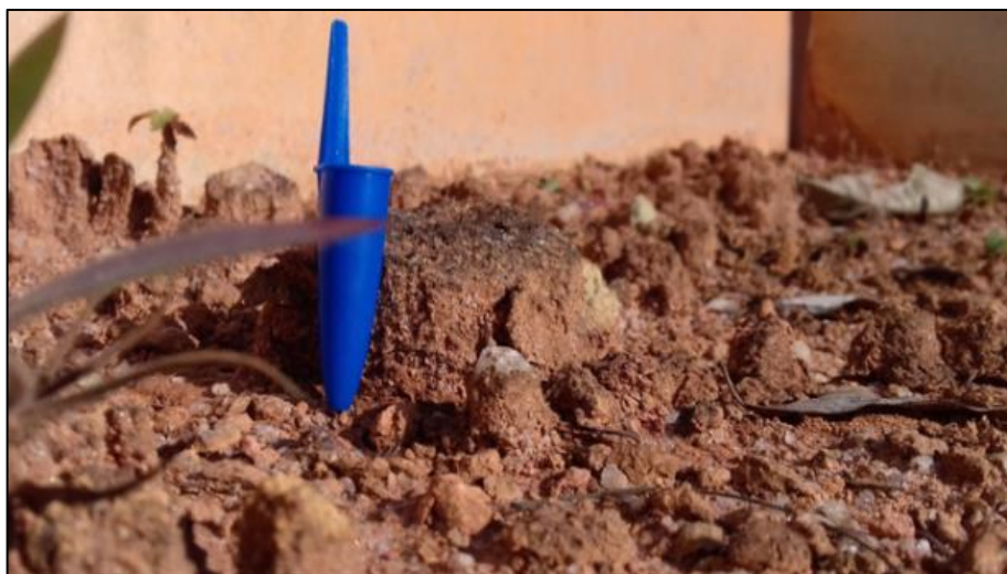
Figura 49. Areia residual e microtopografia do topo do solo das parcelas de erosão, com solo testemunho de 3 cm de altura. Fotos: Leonardo S. Pereira (2016).
