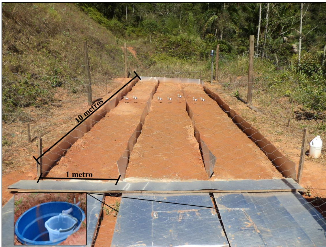
Figura 33. Visão geral das parcelas de erosão, salientando suas dimensões (comprimento e largura) e a caixa de armazenamento do escoamento. Foto: Leonardo S. Pereira (2013).
