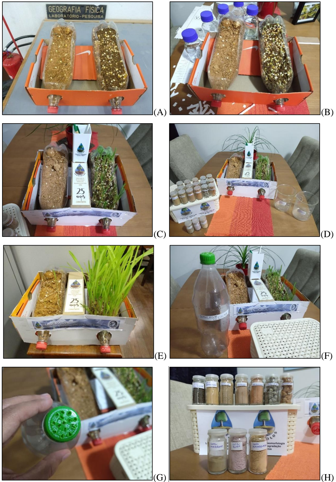
Figura 62. Passos para elaboração do material didático com os solos utilizados na tese. Construção de parcelas de erosão e acompanhamento da taxa de crescimento vegetal (A, B, C, D e E); Confeção de um simulador de chuva (F e G); e kits de solo com distintas propriedades físicas, químicas e mineralógicas (H). Foto: Leonardo S. Pereira (2019).
