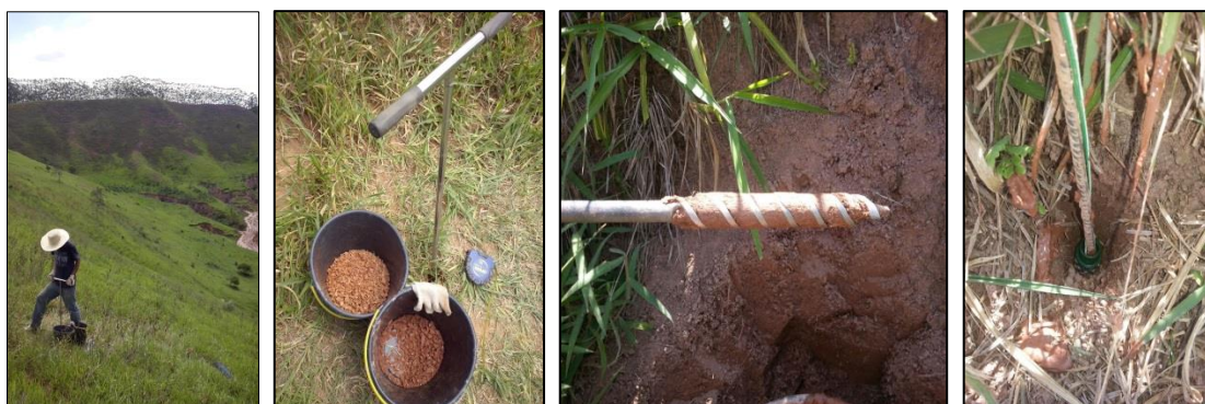
Figura 25: Instalação dos sensores de umidade.
