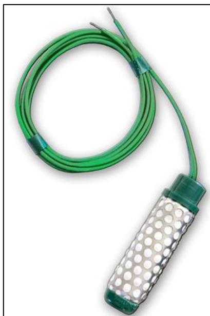
Figura 24: Granular matrix sensor (GMS), Watermark 200ss utilizado para monitoramento. Fonte: Irrometer Company Inc.
