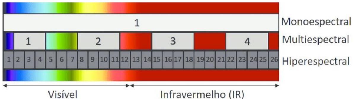
Figura 12: Diferenciação da classificação dos sensores espectrais. (Fonte: LIRA et al, 2016)
