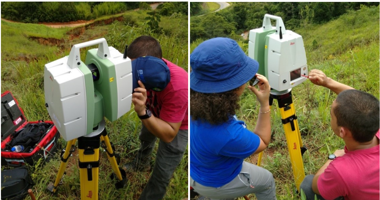
Figura 21 – Etapa de configuração de varredura do Leica Laser Scanner , definindo resolução, área e angulação para escaneamento. Fotos: Diego Janoti (2018); Hugo A. S. Loureiro (2018).
