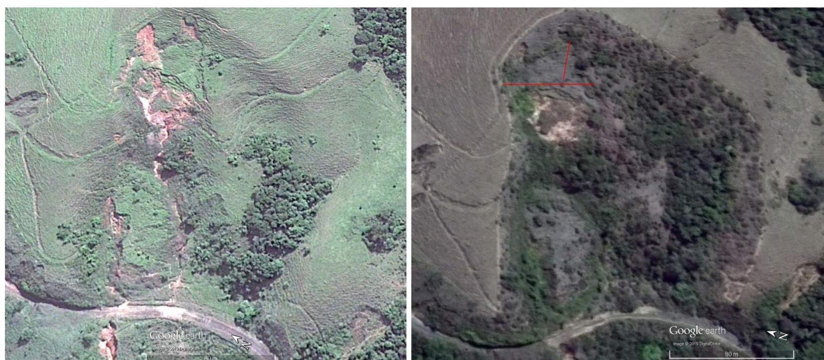
Figura 51 – A imagem de 2011 (à esquerda) define um pouco melhor os formatos da voçoroca B e realça, no limite inferior da imagem, o surgimento de voçoroca à jusante da Linha Férrea. Na imagem de 2017 (à direita), a posição do transecto horizontal (em vermelho) mostra que a definição da parede direita era clara no campo, local onde foi coletada a amostra BPD.
