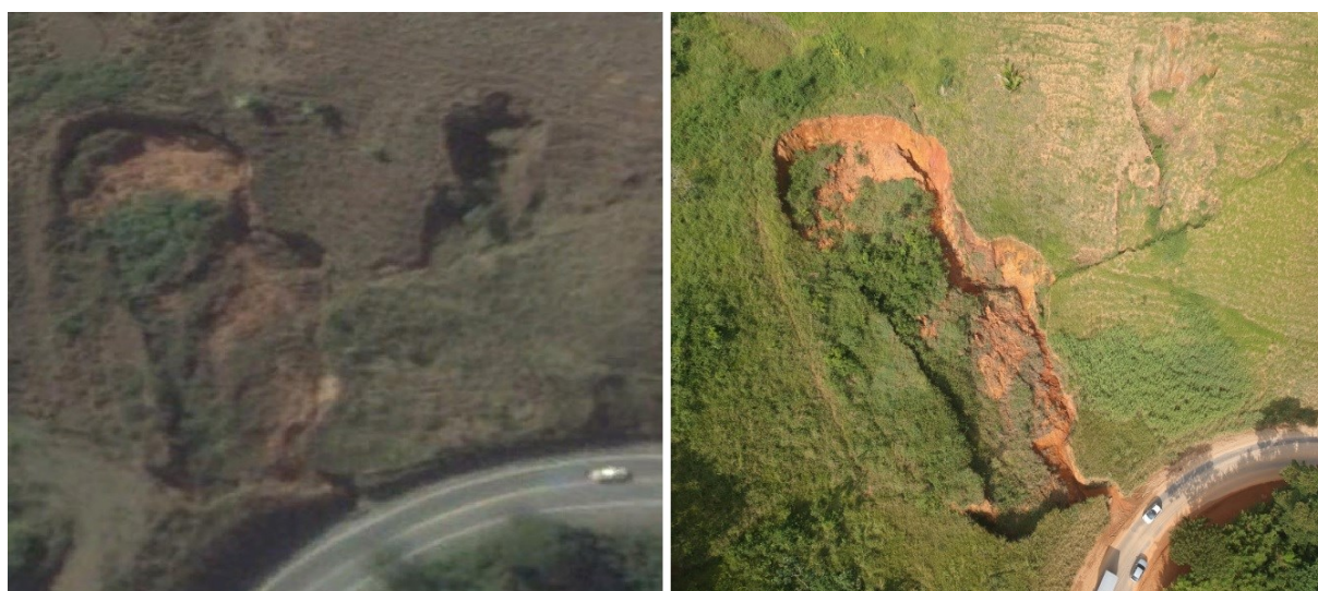
Figura 36 – Comparação da qualidade entre uma imagem de alta resolução espacial disponível no Google Earth e uma foto aérea registrada com VANT, para a área de estudo A. Foto: Fabrizio Garritano (2018).
