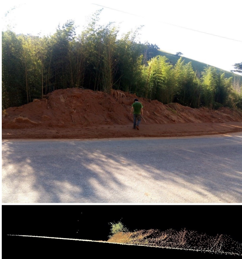
Figura 74 – Superior: foto de março de 2018 mostra o grande acúmulo de solo erodido pela voçoroca A. Inferior: parte da nuvem de pontos mostrando os sedimentos acumulados na pista. Foto: Domyrique Santos (2018).
