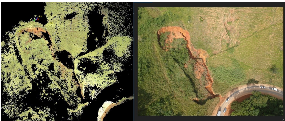
Figura 60 – Nuvem de pontos (à esquerda) e imagem aérea do VANT DJI Spark (à direita). Dos dados obtidos pelo LST foram derivados diversos produtos analíticos, quantitativos e qualitativos. Da imagem digital em alta resolução foram possíveis apenas análises qualitativas. Processamento: Hugo Alves S. Loureiro (2018). Foto: Fabrizio Garritano (2018).
