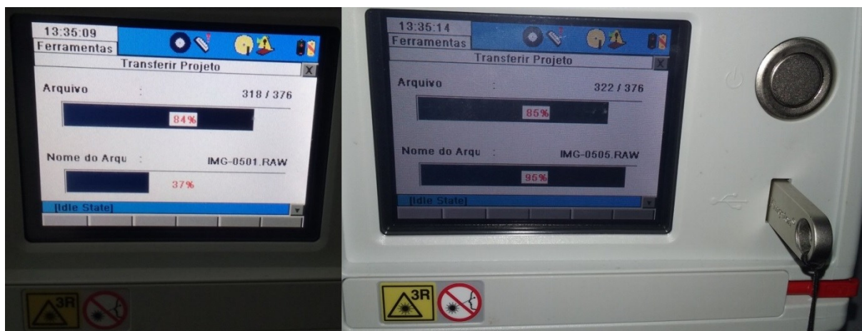
Figura 22 – Transferência dos dados de varredura do Leica Laser Scanner para pen drive. Fotos: Hugo A. S. Loureiro (2018).
