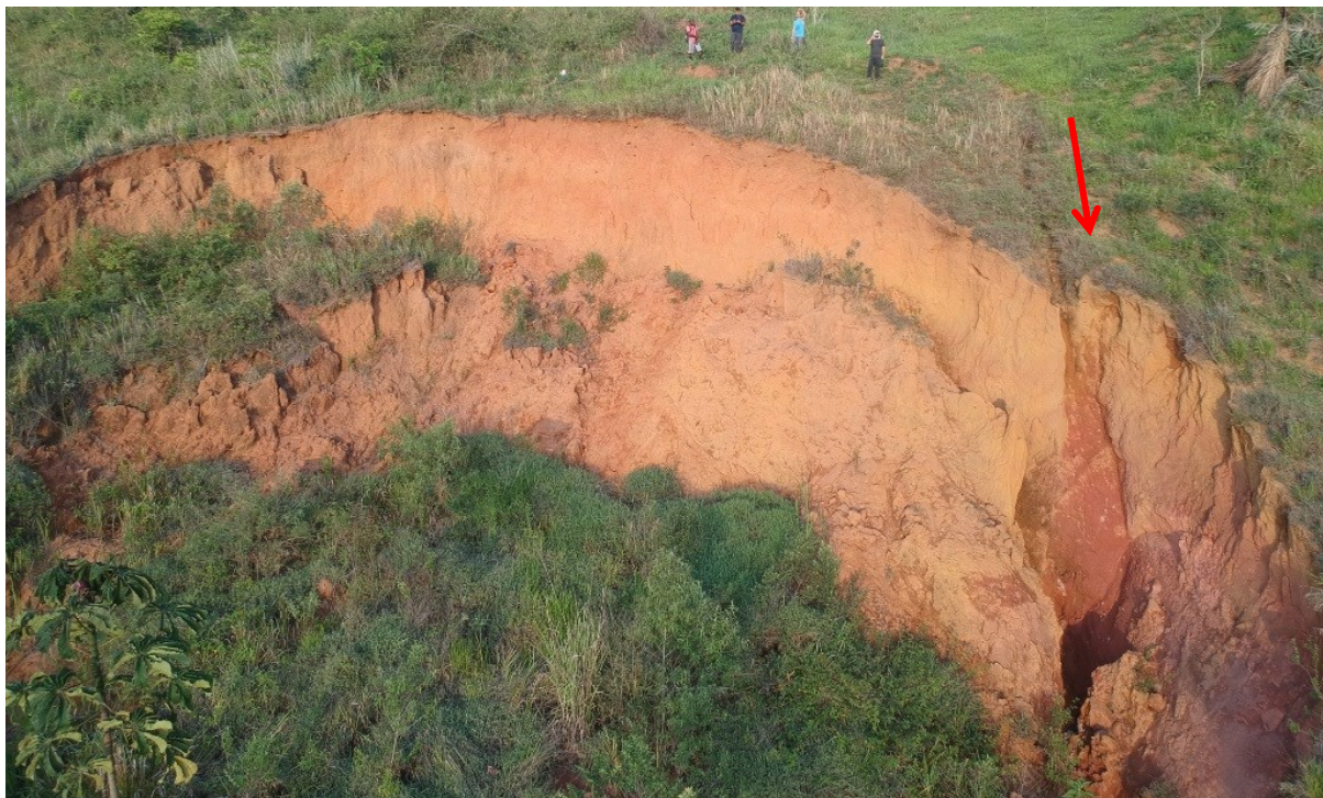
Figura 67 – Fotografia aérea do VANT focalizando a cabeceira da voçoroca A, em dezembro de 2018. Seta destaca caminho preferencial da água. Foto: Fabrizio Garritano (2018).
