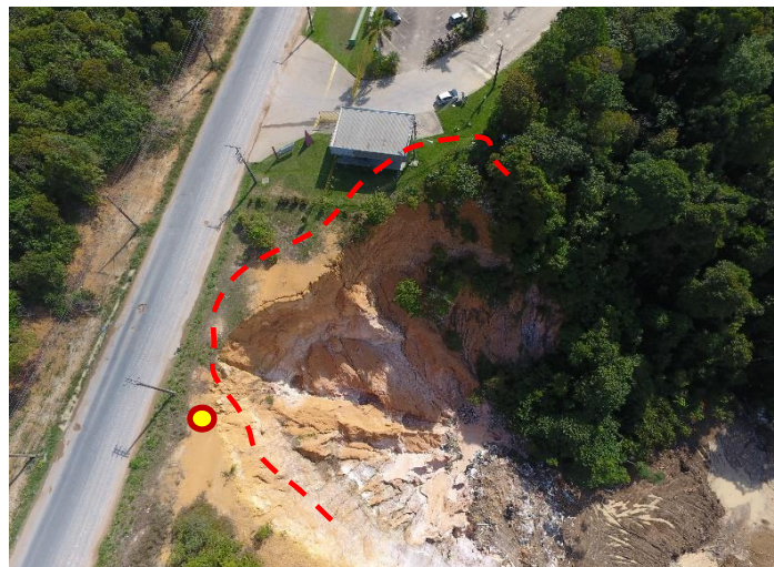
Figura 74: Imagem por VANT do ponto amarelo marca o local de coleta de amostra 02, próximo à borda da voçoroca (linha tracejada em vermelho), na bacia Colônia Antônio Aleixo, Manaus – AM. Fonte: VANT - LATOSSOLO 1, 2018.
