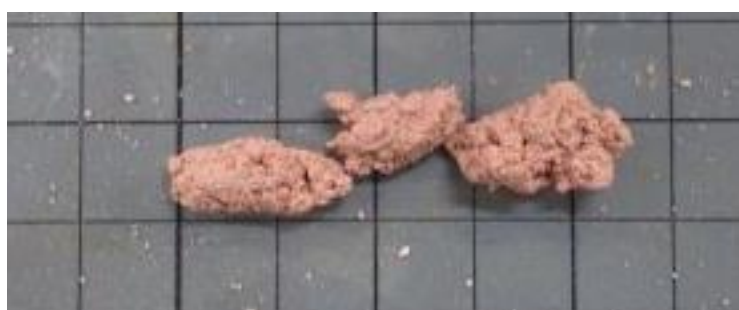
Figura 81: Resultado do teste de plasticidade na amostra de solo no ponto 03, da bacia Colônia Antônio Aleixo. Cada quadrado equivale a 1 cm. Fonte: Armando Brito da Frota Filho.
