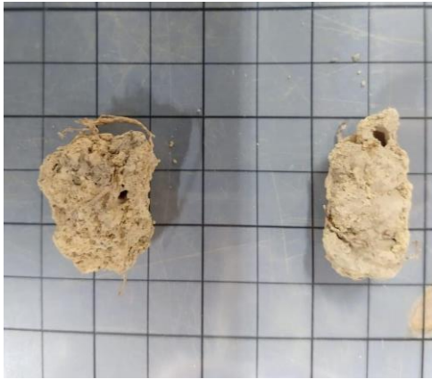
Figura 33: Observação da presença e tamanho. Distribuição dos poros escala papel de 1 cm por quadrado Foto: Amando Brito da Frota Filho, 2018
