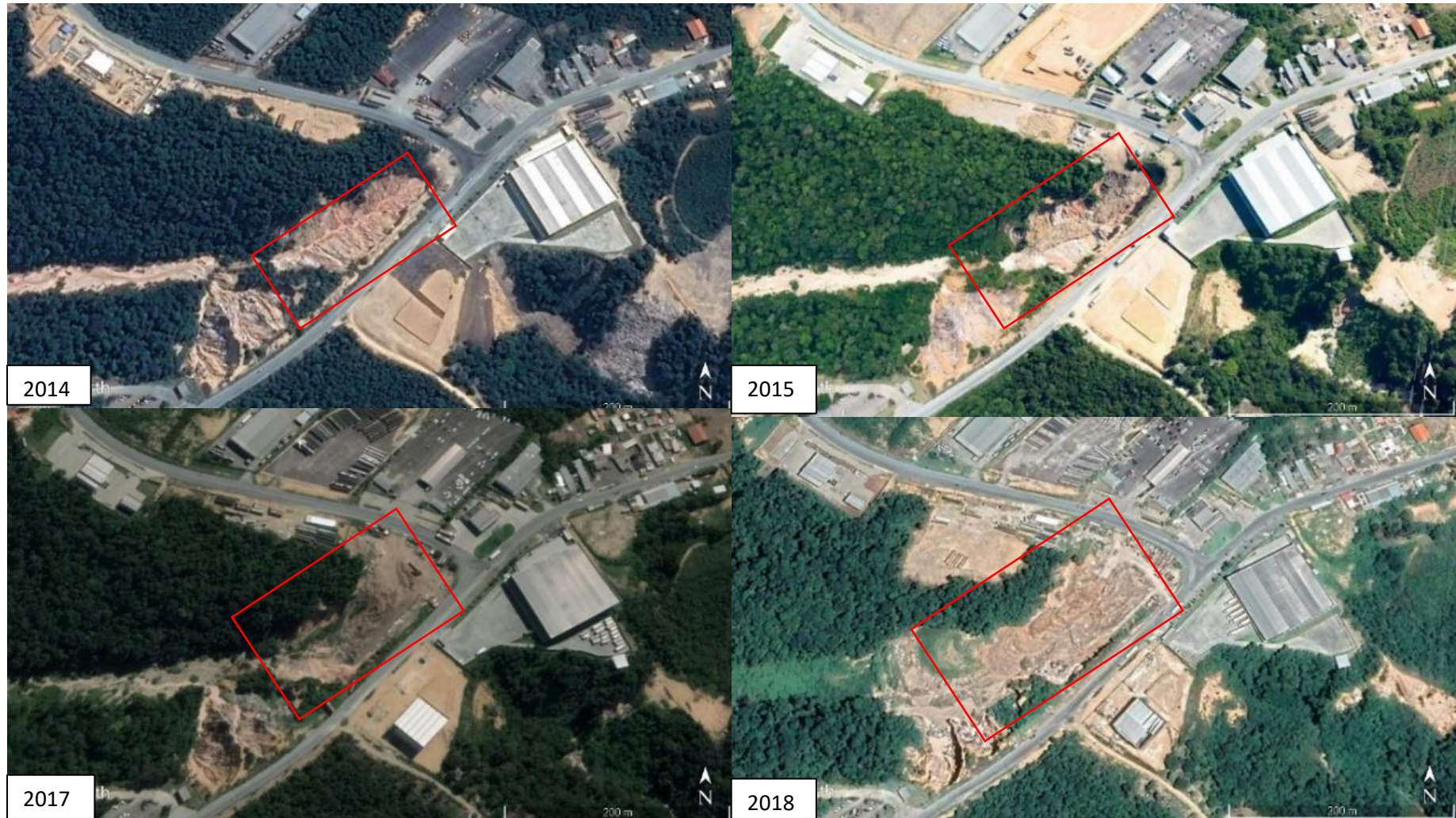
Figura 91: Mosaico com série histórica (anos de 2014; 2015; 2017; e 2018 – escala de 200 metros) da evolução de uma voçoroca pela ação humana sinalizada pelo quadro vermelho, localizado no bairro Distrito Industrial II, bacia Colônia Antônio Aleixo, Manaus – AM. Fonte de Imagens: Google Earth. Org: Armando Brito da Frota Filho.
