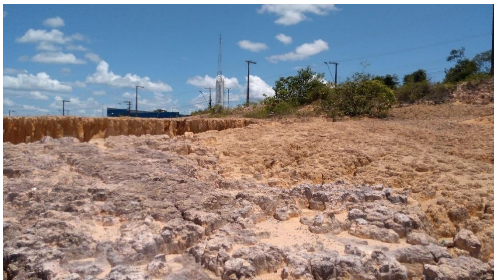
Figura 85: Solo com presença de crostas de alteração pela presença de argilas lateríticas ponto 3, terreno alterado com solo exposto sem ocupação humana, bairro Distrito Industrial II, bacia Colônia Antônio Aleixo. Foto: Armando Brito da Frota Filho, 2020.
