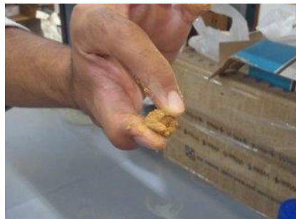
Figura 29: Teste de consistência (dureza). Foto: Armando Brito da Frota Filho, 2018
