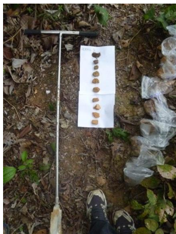
Figura 25: Trado holandês usado para coleta das amostras de solo
