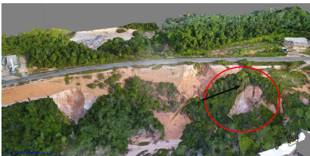
Figura 52: Imagem de voçorocas monitoradas pelo VANT, destaque com círculo vermelho para a incisão localizada em meio à vegetação e a seta preta indicando a mancha na parede da voçoroca originada por uma canaleta. Fonte: Armando Brito da Frota Filho, 2020.
