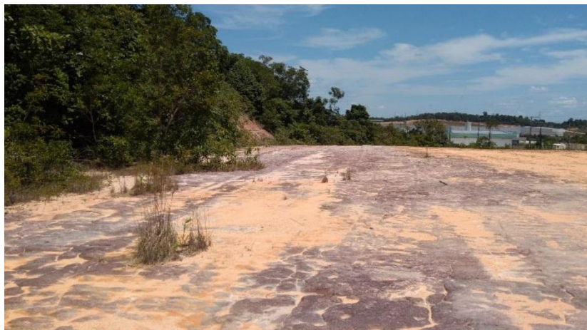
Figura 75: Local do ponto nº 03 de coleta de amostras de solo e realização de teste resistência à penetração e infiltração, bacia Colônia Antônio Aleixo. Notar a presença de crostas ferruginosas. Foto: Armando Brito da Frota Filho, 2018.
