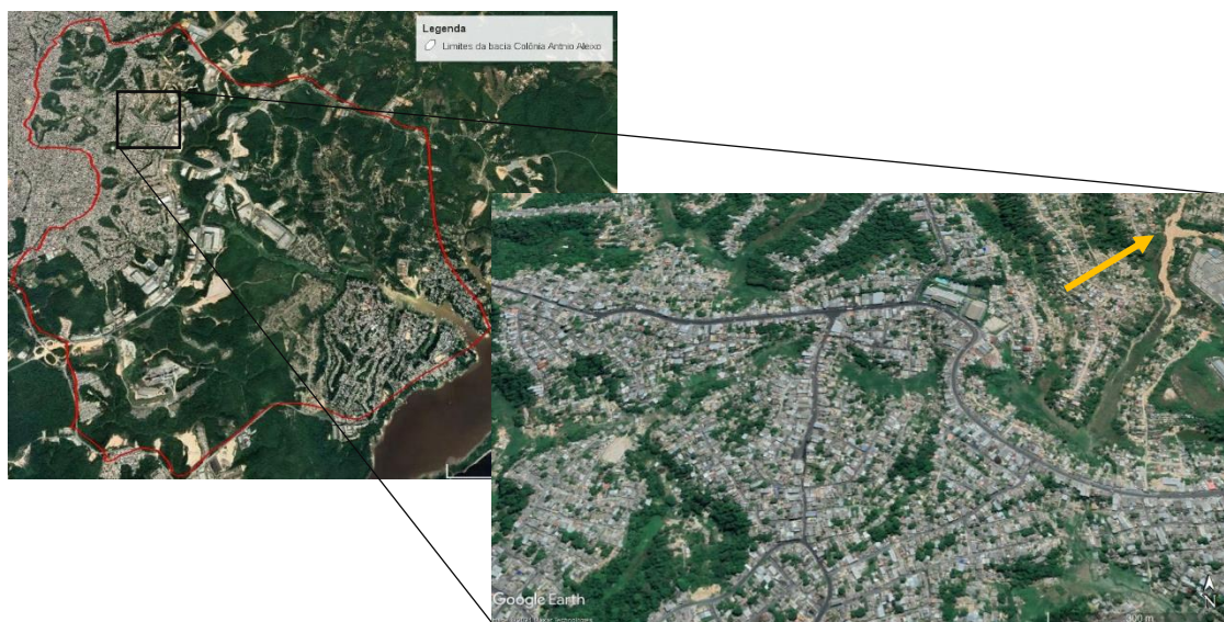
Figura 48: Área representativa do estágio três de urbanização na Bacia Colônia Antônio Aleixo, seta amarela para canal assoreado, resultante dos sedimentos de voçoroca a montante. Fonte: Google Earth, 2021.
