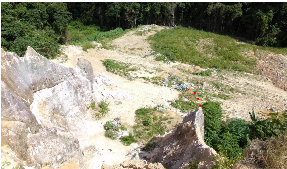
Figura 67: Parte da parede direita da voçoroca 03 colapsada. Em linha vermelha tracejada, simula o formato da parede antes do desmoronamento. Fonte Armando Brito da Frota Filho, 2019.
