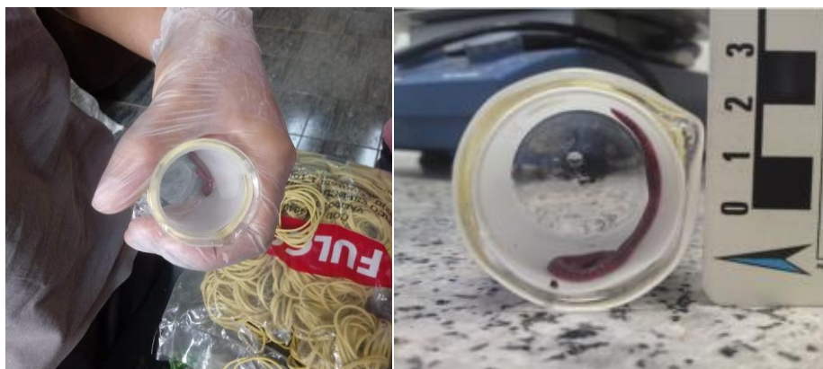
Figura 17 - Minhoca ( Eisenia andrei ) acomodada no interior de um becker de 50mL, para teste agudo de papel de contato
