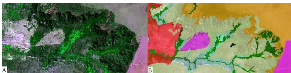
Figura 28 - Processo de segmentação em polígono das imagens (A), e o seu respectivo reajuste e classificação conforme as classes de cobertura e uso do solo (B).
