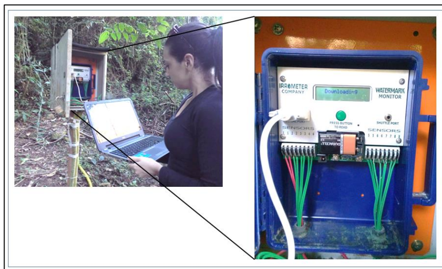
Figura 19: Datalogger da Estação 2 conectado ao notebook para baixar os dados de potencial matricial da água no solo. Na foto ao lado o datalogger em detalhe, sendo possível reparar nos cabos dos sensores conectados, a tela onde visualiza-se os dados, a portabilidade VGA e a bateria (Foto: Rafaela Soares, 23 de maio de 2018).
