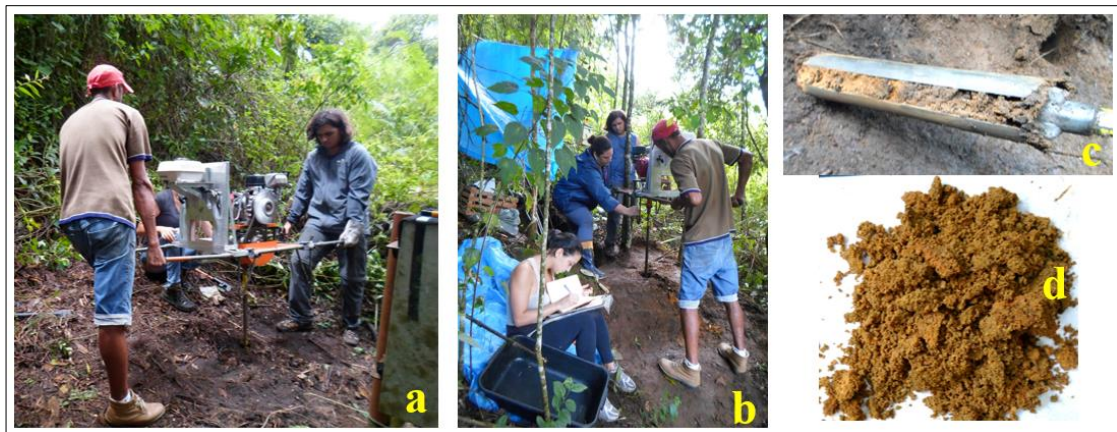
Figura 23: a) Uso do trado motorizado para perfuração do solo, onde foram instalados os sensores da E2; b) Tradagem no interior da trincheira ao lado da E2 e descrição de amostras que estavam sendo coletadas durante a perfuração; c) Amostra coletada na broca do trado; d) Amostra coletada (Fonte: Arquivo pessoal, fevereiro de 2018).
