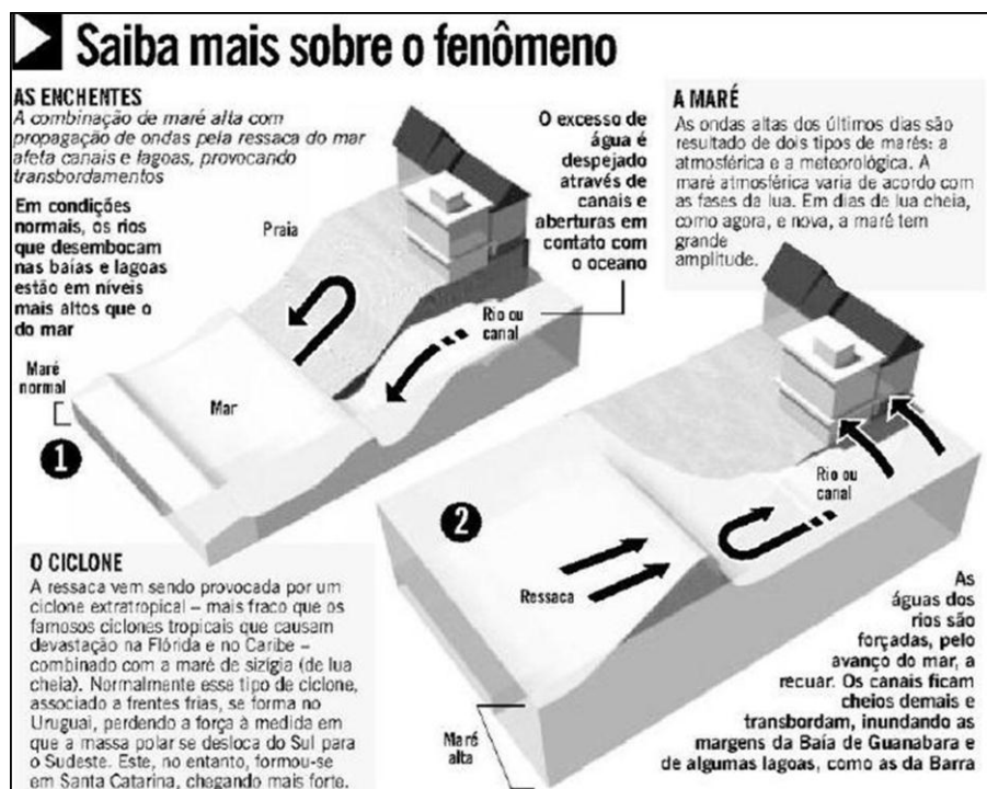
Figura 62: Esquema ilustrativo demonstrando o represamento das águas dos rios por ação das ressacas do mar. Portal Acervo O Globo 8 de Maio de 2001.
