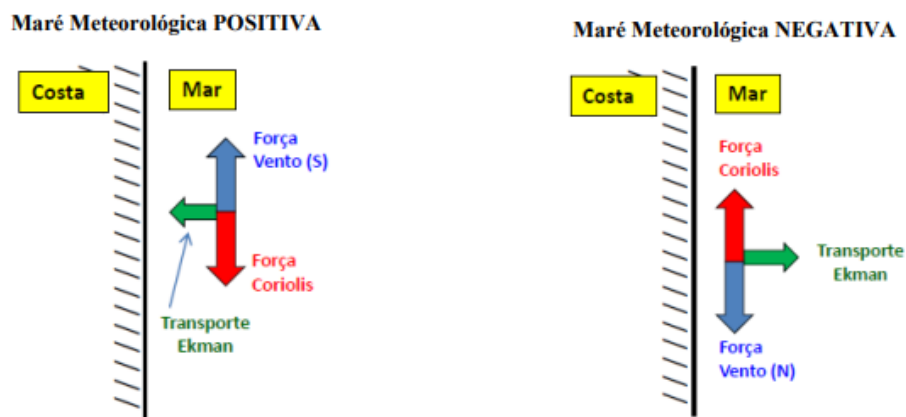
Esquema do Mecanismo Físico para geração da Maré Meteorológica local na Costa S/SE brasileira pelo Vento
