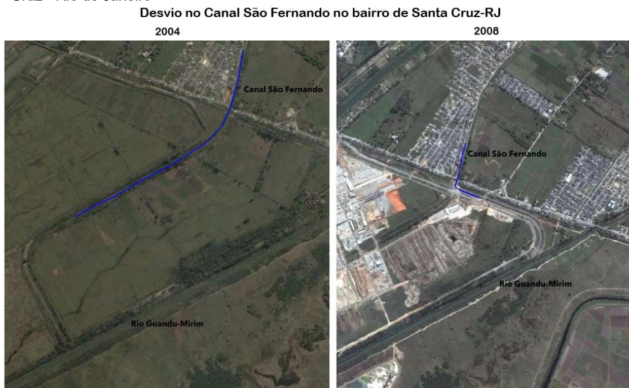
Figura 7: Intervenção hidráulica para desvio do Canal São Fernando no bairro de Santa Cruz - Rio de Janeiro
