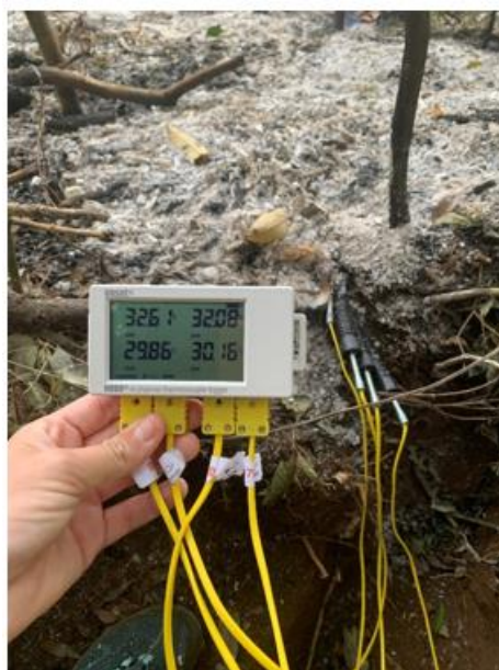
Figura 27. Datalogger e sensores termopar tipo K nas profundidades de 0, 5, 10 e 15 cm.
