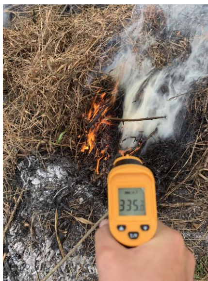
Figura 26. Termômetro infravermelho realizando leitura da temperatura das chamas na gramínea.
