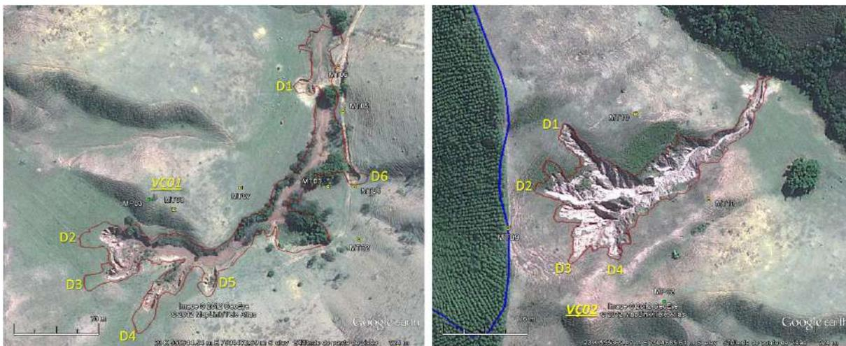
Figura 82 – Situação da Voçoroca 01 (esq.) e 02 (dir.) no dia 21/08/2010. A linha vermelha delimita o contorno das voçorocas em 2012.
