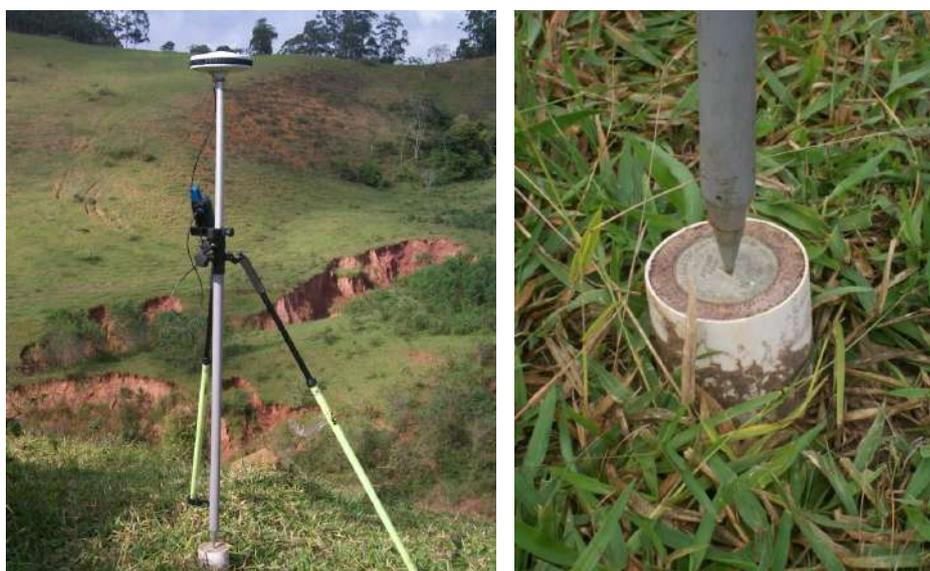
Figura 47 – Procedimento de georreferenciamento dos instrumentos por levantamento relativo estático. Esq.: estação base localizada no marco permanente 03. Dir.: detalhe do marco permanente.
