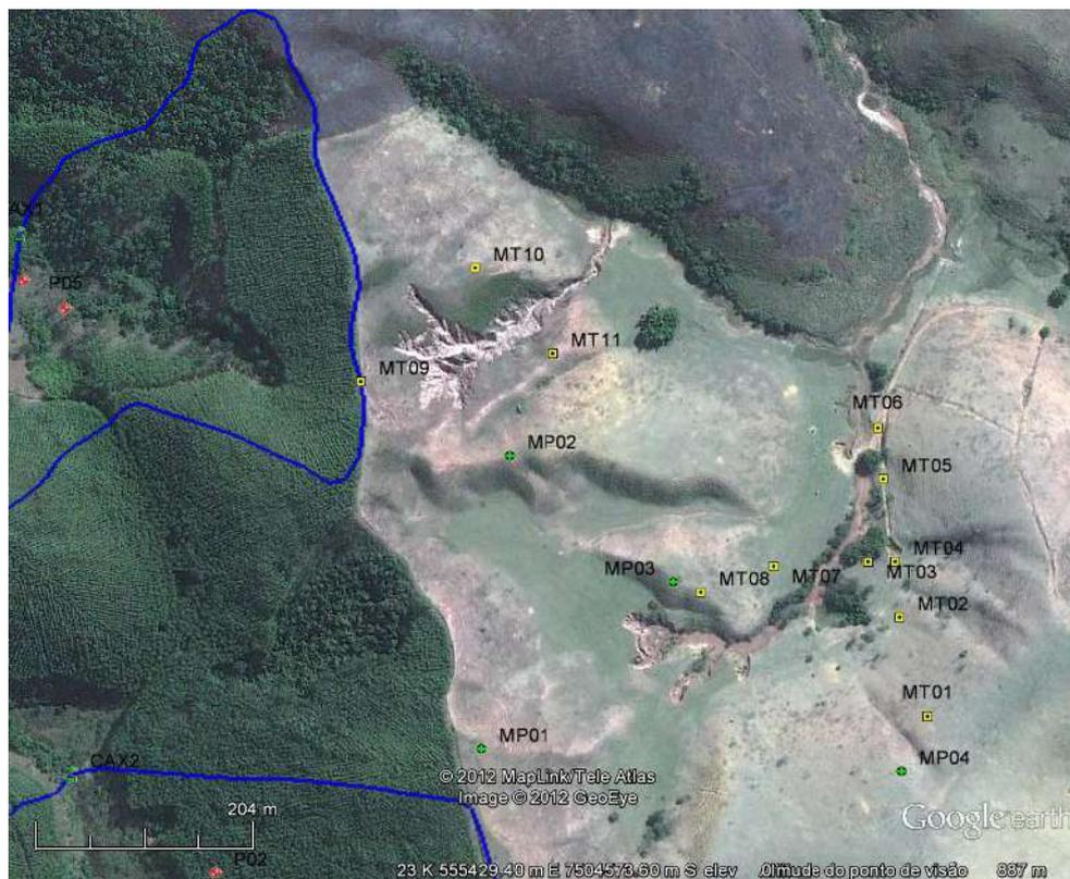
Figura 50 – Rede de marcos permanentes (MP) e temporários (MT) para o delineamento das voçorocas.
