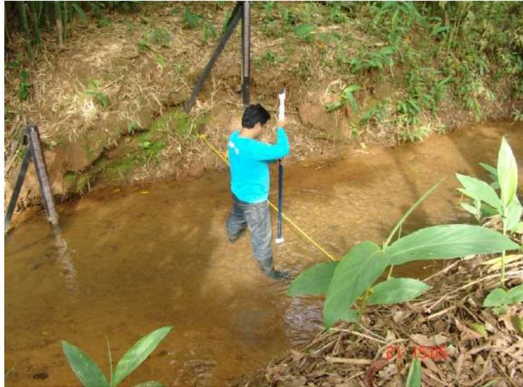
Figura 41 – Medição da vazão a vau com utilização de micromolinete na estação rio São João.
