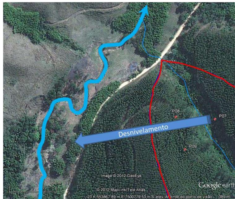
Figura 77 – Estação Independência 01 com a localização dos poços P7 (fundo de vale), P8 e P9 (encosta) e indicação do desnívelamento do NA no sentido do canal do rio Formoso.
