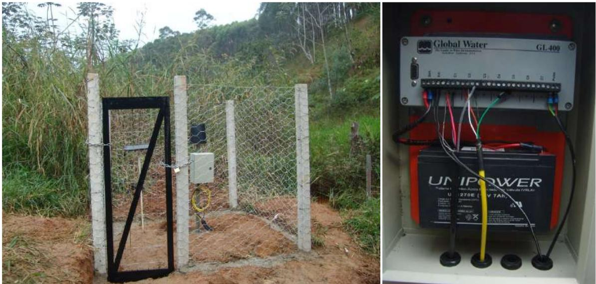
Figura 39 – Estação Caximonan 02. Esq.: cercado para proteção dos equipamentos (painel solar, pluviômetro, caixa estanque, dataloggers e sensores) ao lado do canal com visualização da régua linimétrica. Dir.: detalhe do sistema de aquisição de dados alimentado por bateria no interior da caixa estanque.
