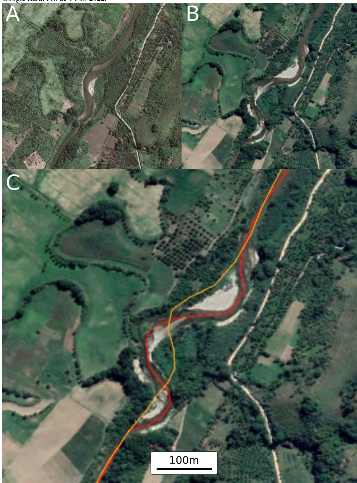
Figura 96 – Trecho do rio Macacu exibindo aumento da migração lateral e consequente aumento da sinuosidade, em Cachoeiras de Macacu, RJ (na foto, o rio flui de cima para baixo). Trecho localizado 2,5 km a sul do Ponto 26. A: Imagem de satélite do Google Earth Pro de 23/03/2010. B: Imagem do satélite do Google Earth Pro de 14/08/2022. C: Linha laranja (canal em 23/03/2010) e linha vermelha (canal em 14/08/2022) sobre imagem do Google Earth Pro de 14/08/2022.
