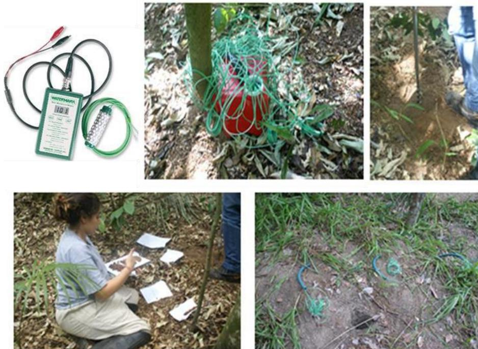
**Figura 16 - A) Leitor manual dos sensores instalados em campo (Irrometer Watermark Soil Moisture); B) Capsulas levadas a campo previamente saturadas; C) Trado de rosca realizando abertura para instalação dos sensores; D) Coleta do solo retirado ao perfurar o solo**
