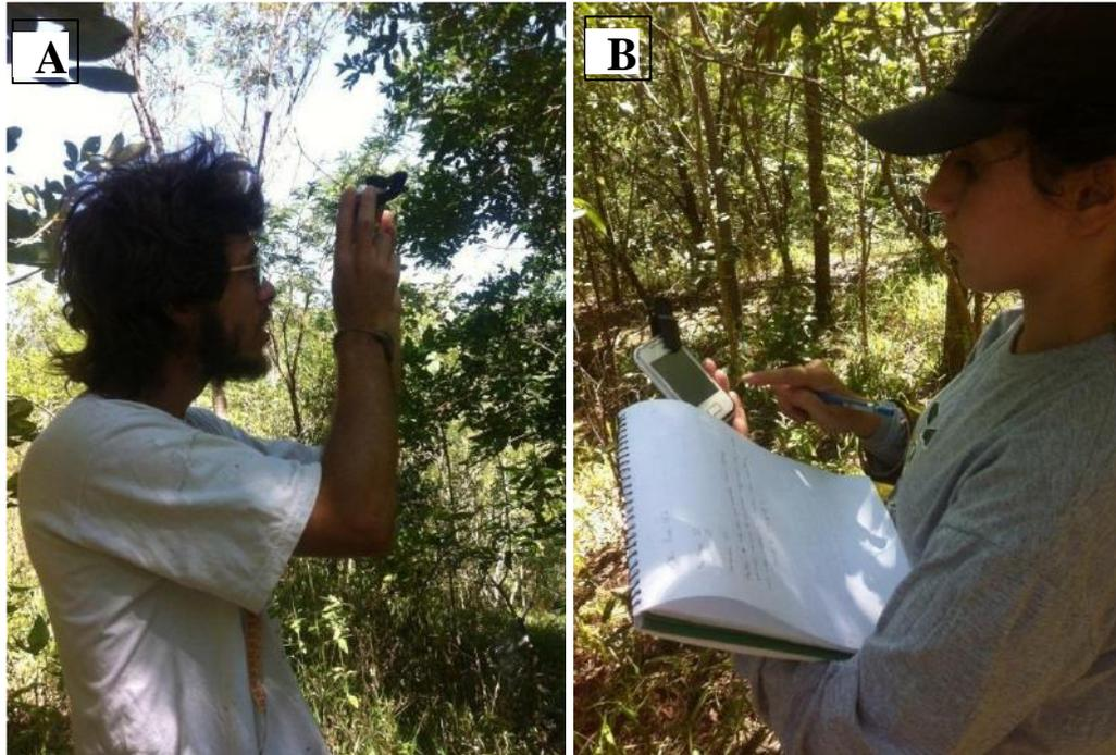
**Figura 19 - - A) Medição da altura (metros) do dossel e B) utilização do GLAMA em campo para mensurar a abertura de copa nos pontos onde foram monitorados o potencial matricial.**
