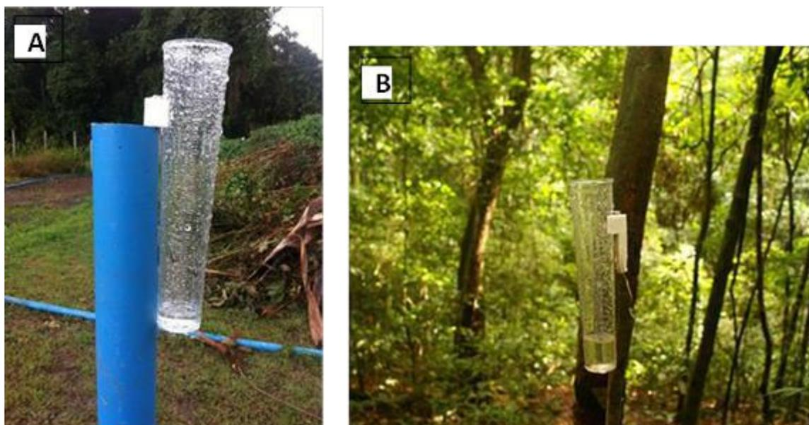
**Figura 18 - Pluviômetros instalados na área controle, sem nenhuma cobertura (A) e área secundária (AS - B).**
