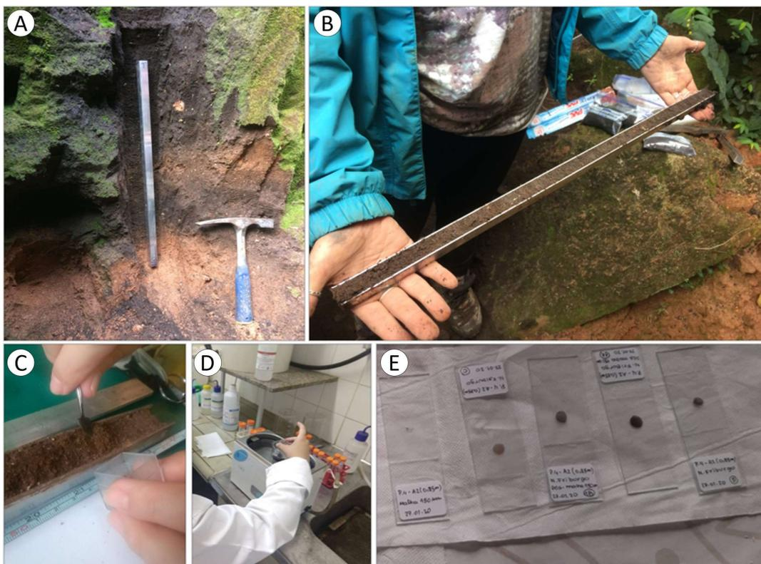
Figura 35 - (A) Perfil na encosta-piloto da bacia do rio Roncador (Campo do Coelho); (B) coleta de amostra no perfil com canaletas de alumínio esterilizadas; (C) retirada do cubo amostral de 8 cm<sup>3</sup>; (D) tratamento químico para a confecção das lâminas; (E) detalhe da preparação das lâminas para identificação por microscopia junto ao Laboratório de Palinologia (UFRJ).
