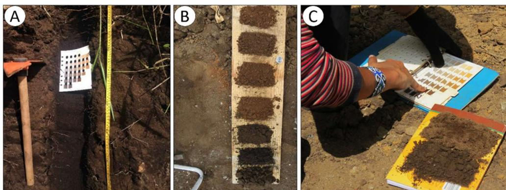
Figura 33 - (A) Limpeza do perfil e identificação da profundidade; (B) Separação das camadas pela diferenciação de cores; (C) identificação das cores através da Carta de Munsell.
