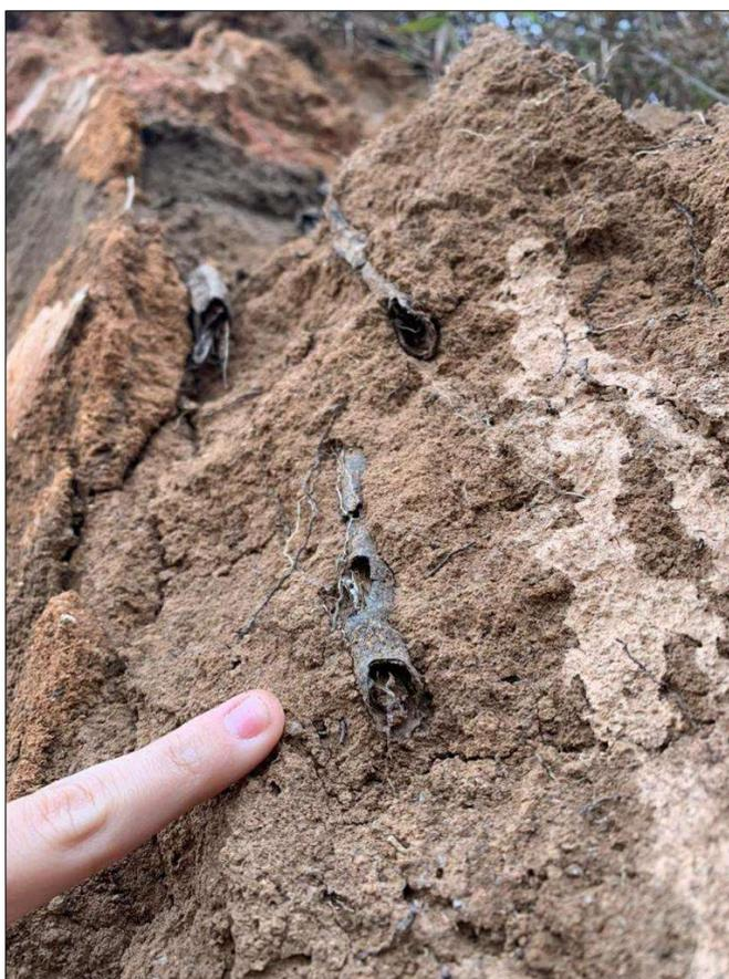
Figura 87 - Entubamentos no solo por raízes mortas decompostas abaixo de um paleo-horizonte A. Esses enraizamentos favorecem a entrada e percolação d'água em subsuperfície porém não confere o efeito de ancoragem no solo, comprometendo a estabilidade da encosta ((Foto: Ana C. Facadio e Leticia.Bolsas).
