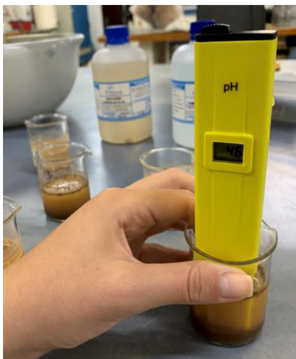
Figura 8: Medição do pH com o medidor digital portátil (Silva, 2021).
