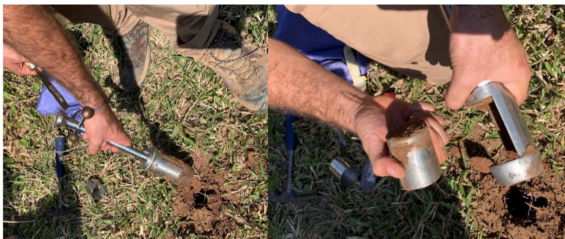
Figura 6: Coleta de amostras indeformadas com amostrador volumétrico (de 100 cm 3 ) em Rio Claro-RJ. (Silva, 2021).
