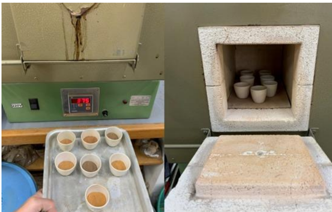
Figura 9: Forno mufla a 375°C e cadinhos de porcelana com amostra de solo (Silva, 2021).
