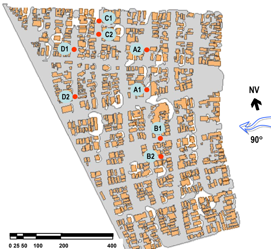
Figura 6.20: Figura de erosão para a direção do vento 90^\circ - U_{ref} = 10,7\text{m/s} .
