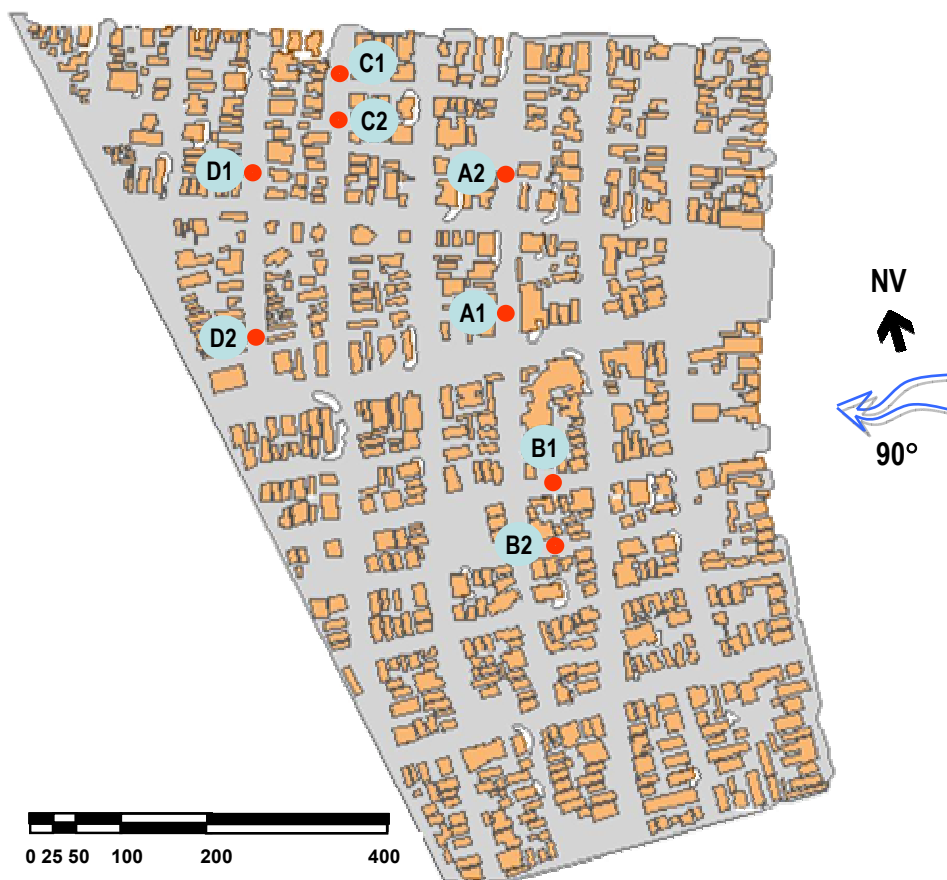
Figura 6.16: Figura de erosão para a direção do vento 90° - U_{ref} = 8,0\text{m/s} .
