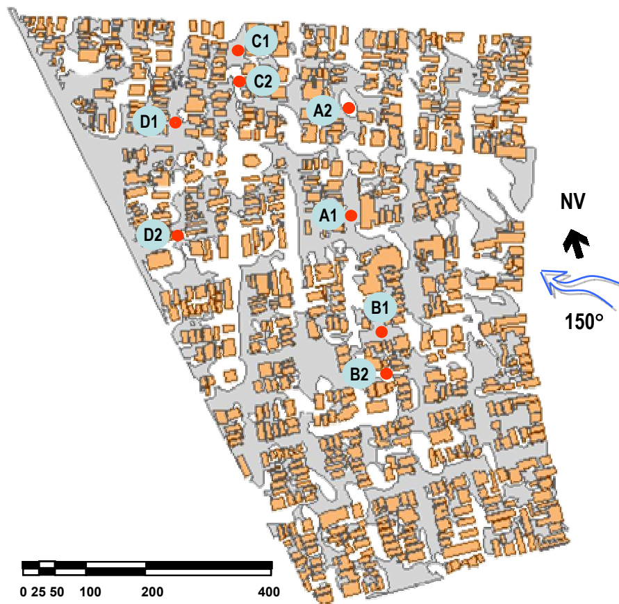
Figura 6.13: Figura de erosão para a direção do vento 150° - U_{ref} = 14,7\text{m/s} .
