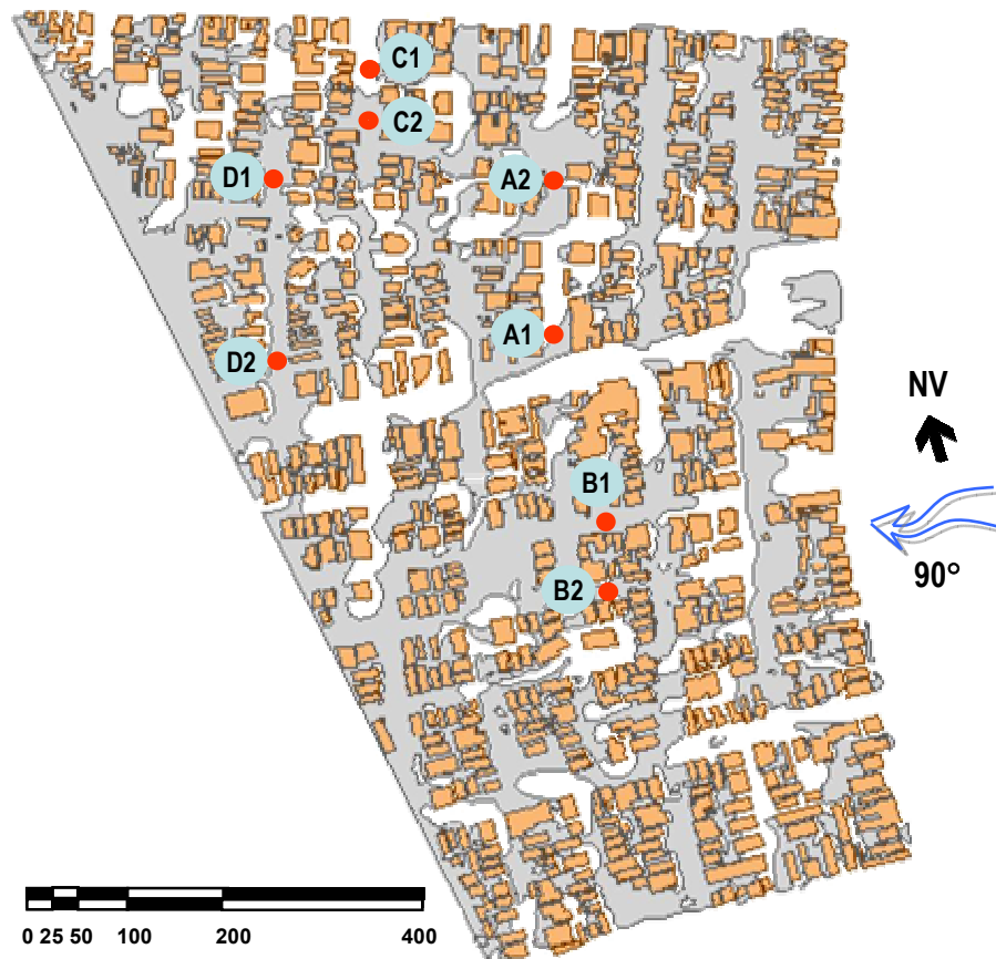
Figura 6.26: Figura de erosão para a direção do vento 90^\circ - U_{ref} = 14,7\text{m/s} .
