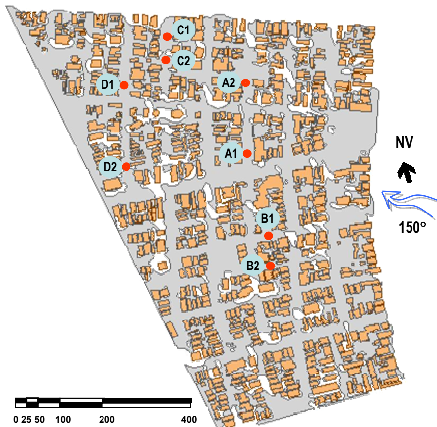
Figura 6.9: Figura de erosão para a direção do vento 150° - U_{ref} = 12,1\text{m/s} .
