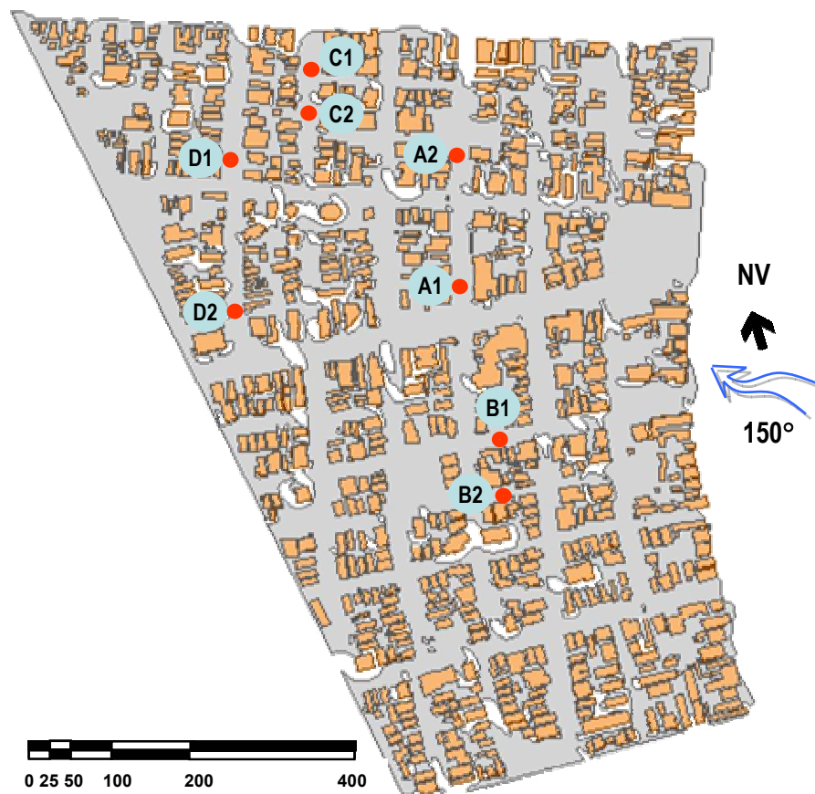
Figura 6.7: Figura de erosão para a direção do vento 150° - U_{ref} = 10,7\text{m/s} .
