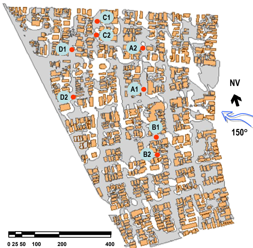
Figura 6.11: Figura de erosão para a direção do vento 150° - U_{ref} = 13,4\text{m/s} .
