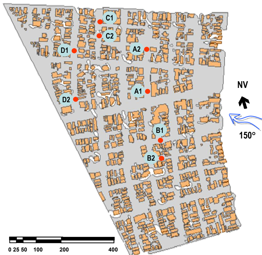
Figura 6.5: Figura de erosão para a direção do vento 150° - U_{ref} = 9,4\text{m/s} .
