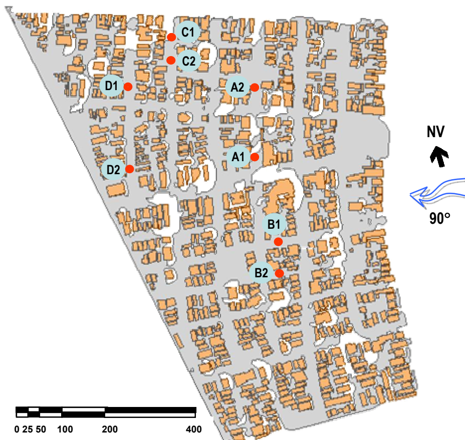
Figura 6.22: Figura de erosão para a direção do vento 90° - U_{ref} = 12,1\text{m/s} .
