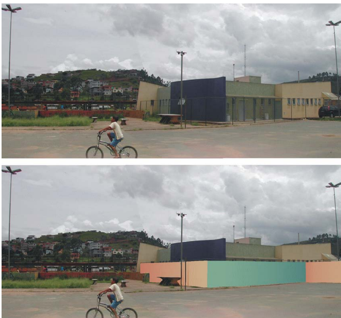
Figura 4.37: Proposta de inserção de barreira acústica para a UBS Vila Esperança.
