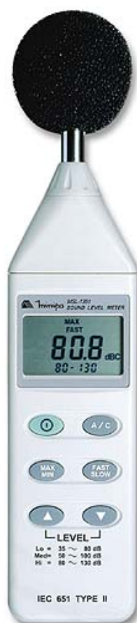
Figura 3.1: Decibelímetro MSL-1352, usado para medições acústicas nas UBS's.
