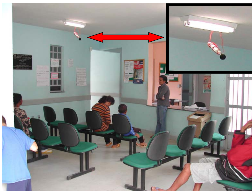
Figura 4.12.: Adaptação do decibelímetro no teto da área de espera da UBS Vila Esperança.
