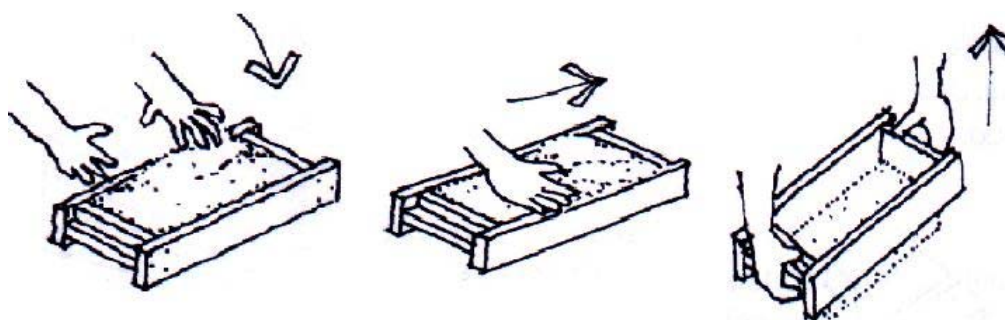
Figura 84 - Etapas da fabricação de tijolo de adobe. Adaptado pela autora. Fonte: LENGEN, 2004, p.305.
