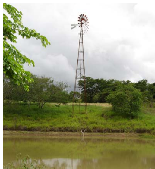
Figura 313 - Açude com água bombeada através de energia eólica. Fonte: RAINHO, 2005.
