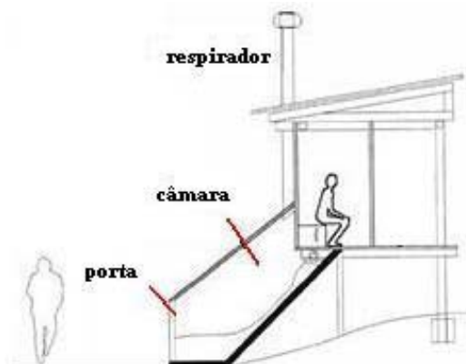
Figura 65- Corte esquemático do sanitário seco. Fonte: ESTRADA, 2005.
