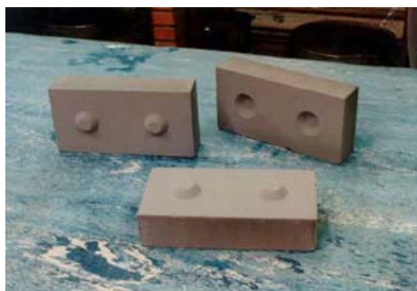
Figura 93 -Tipos de tijolo de solo cimento utilizados em algumas construções da Caixa Econômica Federal. Fonte: https://webp.caixa.gov.br/liminacao/popup/pop_fotos.asp?item=sc&limin=14 . Acesso em: 05 out.2005.
