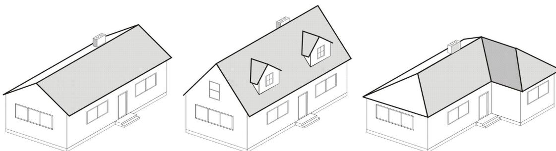
Fig 32: Três exemplos de telhados inclinados ou *Pitched roofs*: (Esquerda para direita); *Gable*, *gable com dormers* e *hip*.
