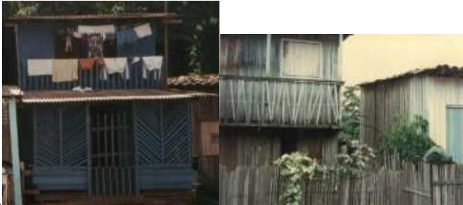
Figura 98: A madeira em forma de ripa, compondo fachadas, balcões e cercas
