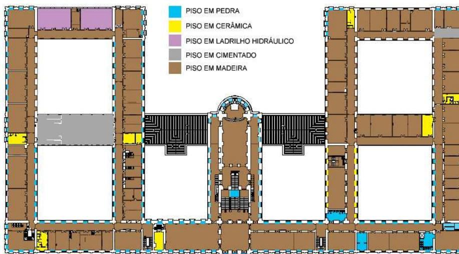
Fig. 71: Planta de pavimentações do 2º pavimento.
