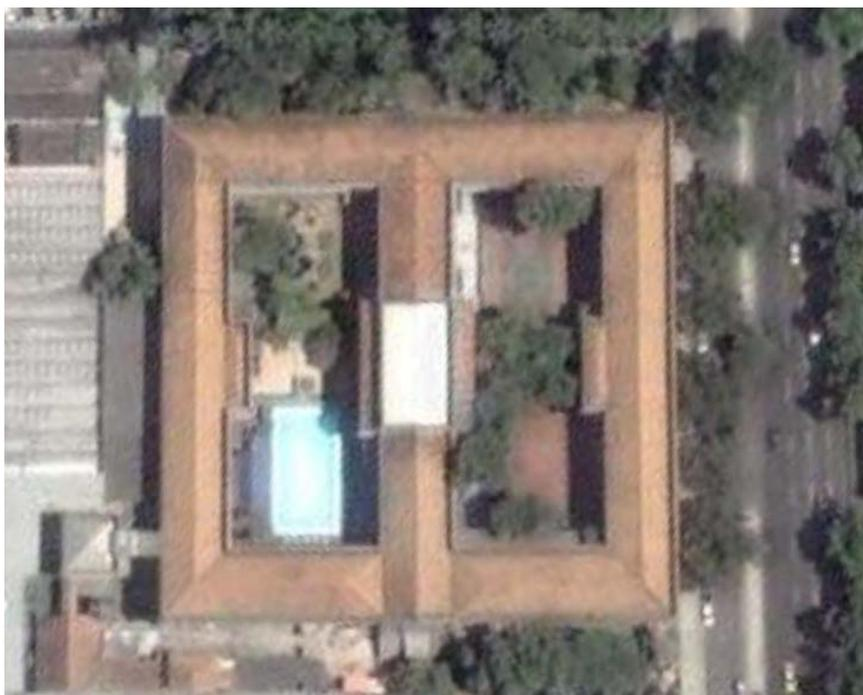
**Figura 145 – Fotografia aérea da Casa Daros, mostrando os dois pátios internos. Ao centro, o segundo pavimento adicionado destaca-se pela cobertura de telhas de fibrocimento. Fonte: Projeto de Restauração do Antigo Educandário Santa Teresa – Velatura Restaurações, 2005.**
