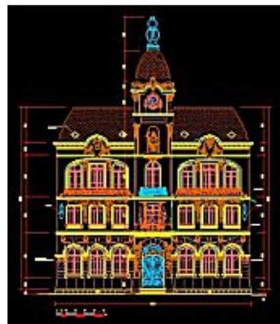
**Figura 18 – Restituição fotogramétrica da fachada frontal do Museu Paranaense. Fonte: <http://www.esteio.com.br>, acesso em 06/07/2006.**
