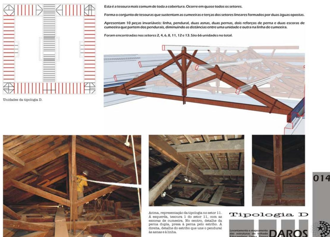
Figura 74 – Exemplo de uma prancha de apresentação de um tipo de tesoura, usando o recurso das imagens em 3D e as fotografias. A imagem retirada do modelo 3D permite a visualização completa de qualquer peça isolada ou de um grupo de peças. Fonte: Projeto de restauração do Antigo Educandário Santa Teresa – Velatura Restaurações, 2005.
