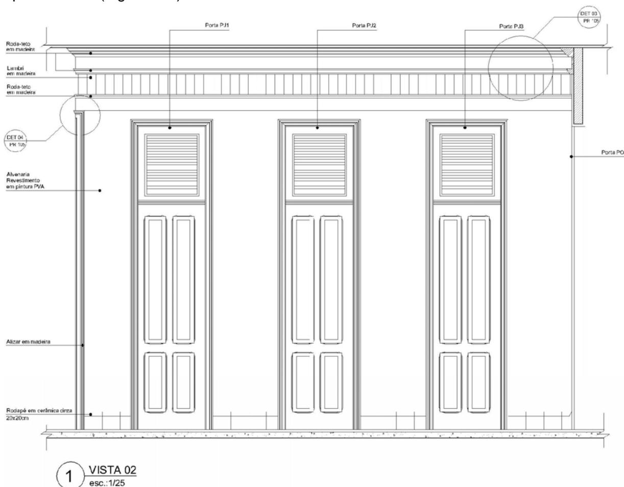
**Figura 130 – Exemplo de elevação com indicação dos elementos e seus materiais e dos detalhes, mas faltam as cotas. Fonte: Projeto de Restauro RB762/UFRJ, 2003.**
