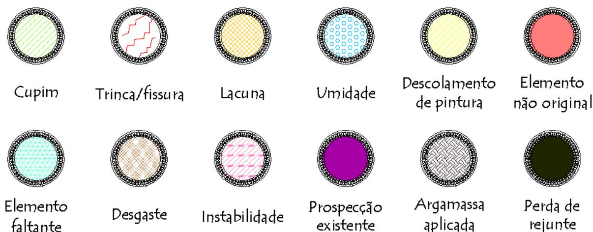
**Figura 84 – Exemplo de legenda de danos usada para o levantamento de vários elementos construtivos em um patrimônio. Alguns danos, neste caso, foram representados por cores sólidas, pois eram muito pequenos para serem visualizados através de hachuras. Fonte: Projeto de Restauro da Villa do Museu Mariano Procópio, 2006.**
