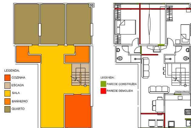
Figura 52: Modificações realizadas pelos moradores na tipologia “F e G” Fonte: AUTOR, 2006
