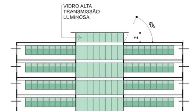
Figura 59 - Detalhe do átrio - modelo M1-G
