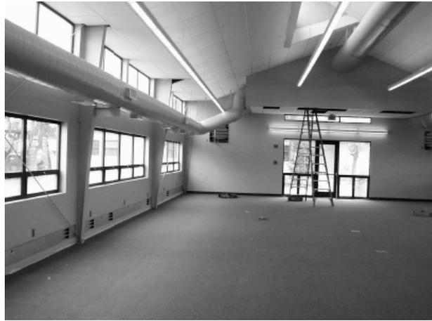
Figura 12 - Aberturas diferenciadas para visão e para iluminação em escritório panorâmico. Fonte: SOUT CALIFORNIA EDSON (1999)
