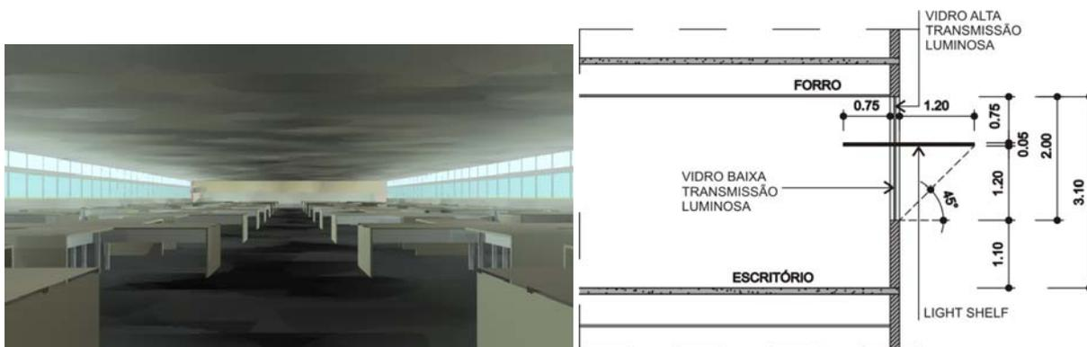
Figura 113 - Vista interna e detalhe modelo M2-C
