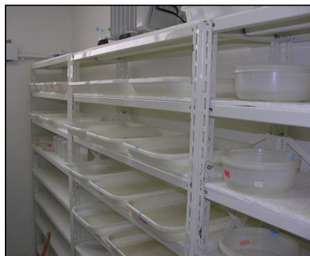
**Figura 54:** estantes com proteção de isopor para estantes não vazadas.
