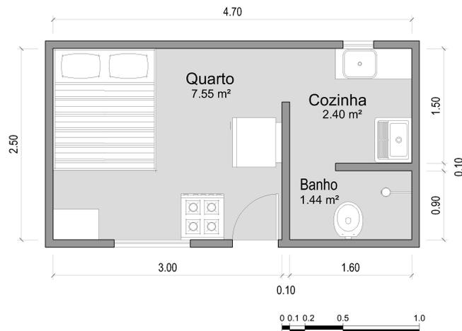
Figura 50: Planta baixa da casa com 11.39 m<sup>2</sup>.
