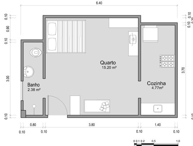
Figura 57: Planta baixa da casa com 22,35m<sup>2</sup>.
