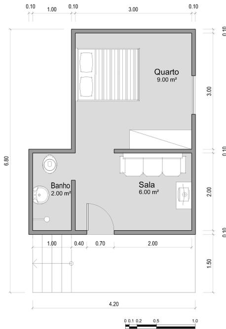
Figura 54: Planta baixa da casa com 17 m<sup>2</sup>.
