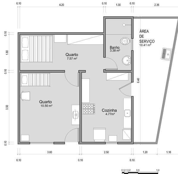
Figura 63: Planta baixa da casa com 35,63m<sup>2</sup>.
