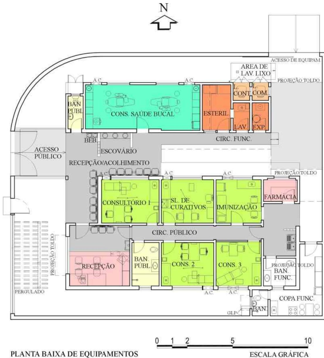
Fig. 28 – Planta Baixa de Arquitetura e de Layout de Equipamentos Fonte: CIESZO.
