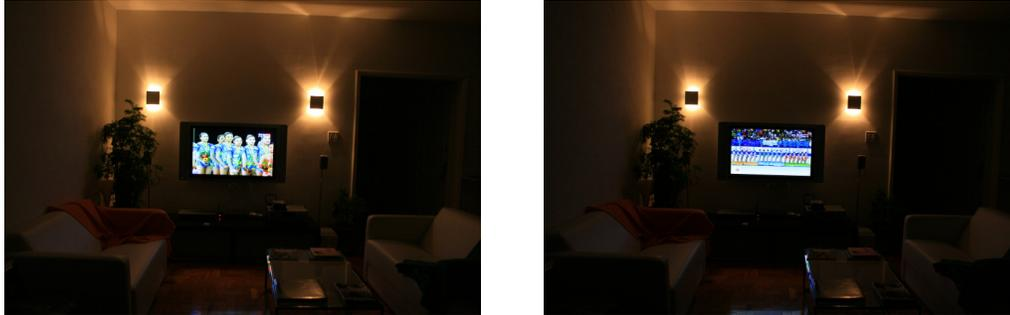
Figura 67 – Dimerização das lâmpadas halógenas nas arandelas. (a) em 35%; (b) em 25%.
