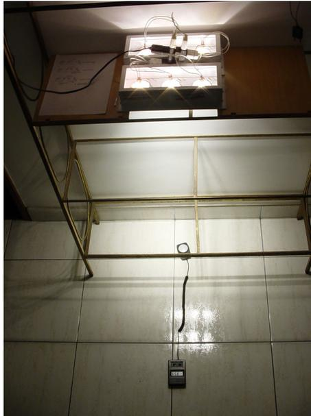
*Figura 34* – Foto ilustrativa da montagem da experiência. Aparecem duas luminárias cada uma com três lâmpadas dicróicas voltadas para baixo, instaladas a um metro do chão. Em baixo é possível observar o luxímetro. Momento em que o *dimmer* está ligado ao máximo – nível 10.
