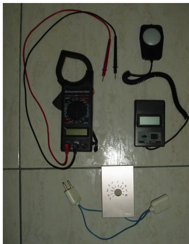
*Figura 35* – Foto com os instrumentos de medição e dimmer utilizados na experiência. (Alicate Amperímetro Digital: Modelo - 266, Fabricante - Force Line), (Luxímetro: Modelo - LD-500, Fabricante – ICEL) e (Dimmer 300W 127 V Rio Vectra – vale ressaltar que o *dimmer* foi marcado com números de 1 a 10. Esses números representam os 10 níveis de iluminação a serem medidos).
