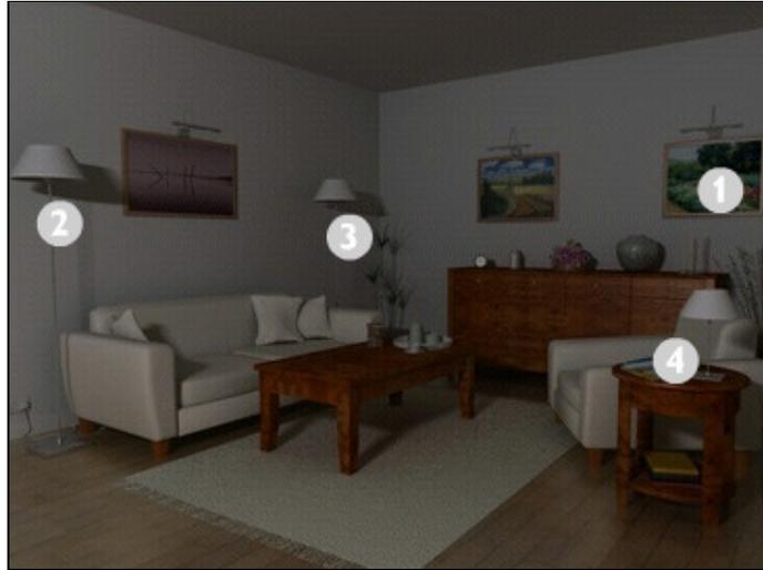
*Figura 13* - Todas as lâmpadas apagadas. Foto ilustrativa. Quatro circuitos numerados: 1 - para três arandelas de quadro; 2 - para coluna da esquerda; 3 - para coluna ao fundo; 4 - para abajur. (Fonte: site da Philips iluminação versão holandesa).
