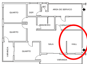
Figura 1.29 – Hall de entrada como filtro entre exterior e interior na década de 1930.
