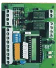
Ilustração 64 – Módulo de laço de detecção ( placa e gabinete)
