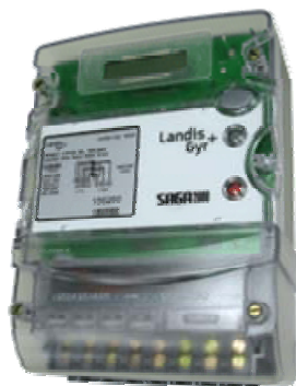
Ilustração 86 - Medidor eletrônico de energia ativa, reativa e demanda. Fonte: Landis & Gyr - modelo SAGA 2000 – agosto2007
