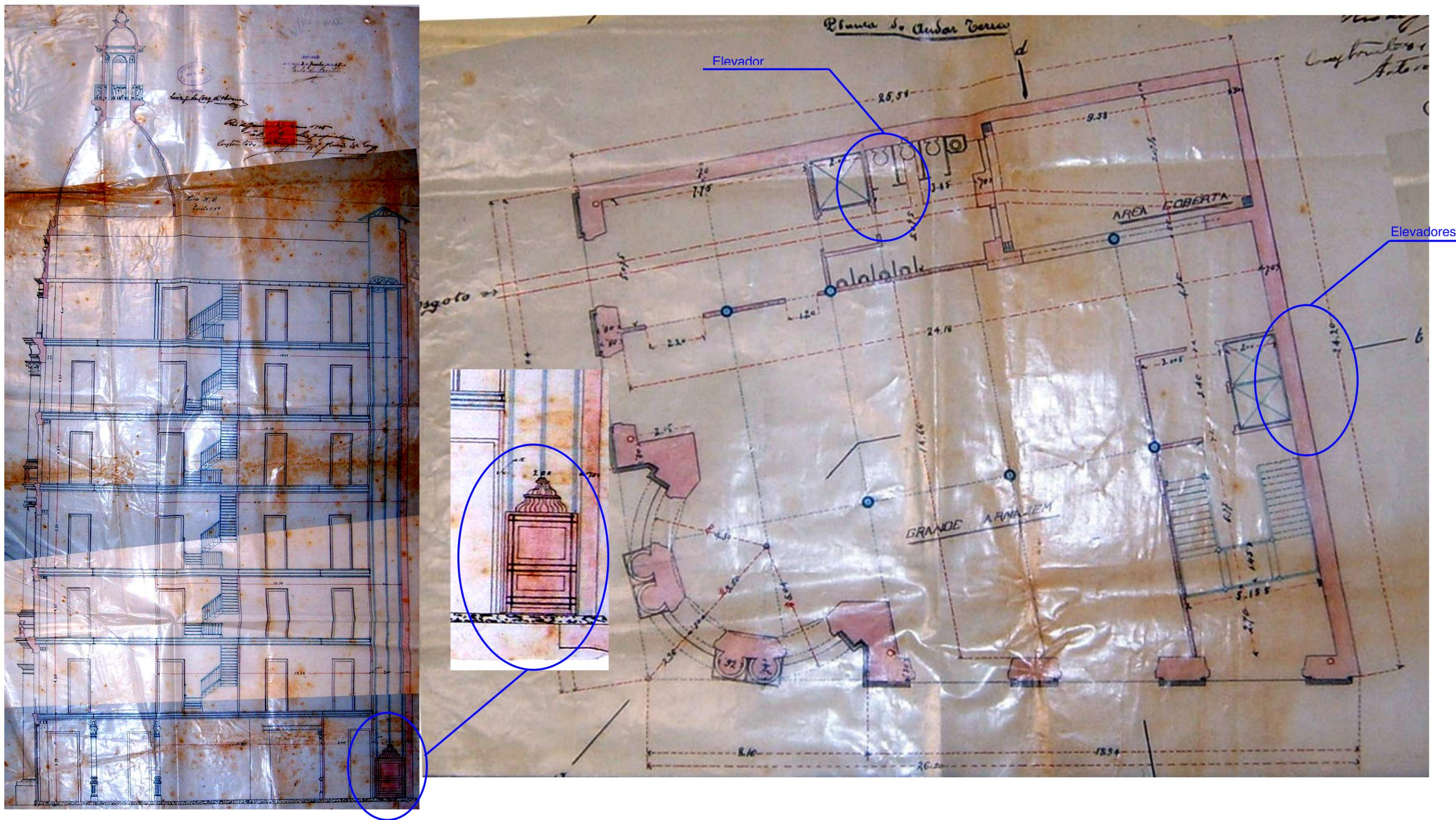
**Ilustração 79** – Corte longitudinal e planta baixa do pavimento térreo do Projeto para aprovação da construção do prédio de nº. 107/109, de propriedade de Eduardo Palassim Guinle e com autoria e construção de Antonio Jannuzzi (esquina com a Rua do Rosário), com a indicação de 3 elevadores projetados. Pela descrição da matéria do jornal parece ser o prédio referido no artigo do Jornal do Brasil. No detalhe, corte da cabine e da caixa do elevador (Arquivo Nacional).
