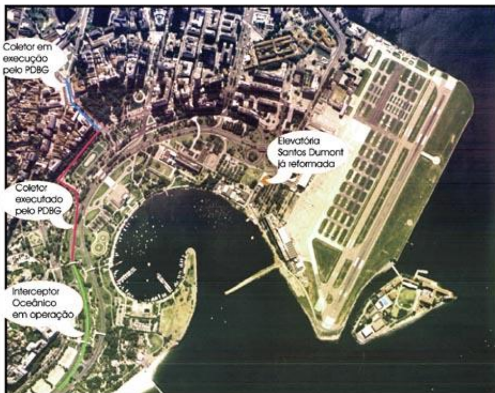
Figura 5. 9 Marina da Glória - Sistema coletor em execução, que fará a interligação do centro da cidade com o emissário de Ipanema (SEMADUR).
