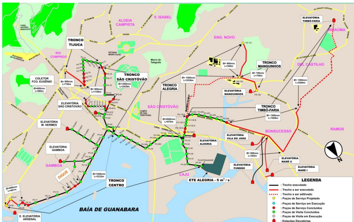
Figura 6. 24 Rede de Coletores Tronco do Sistema de Coleta e Tratamento de Esgoto de Alegria (ADEG)
