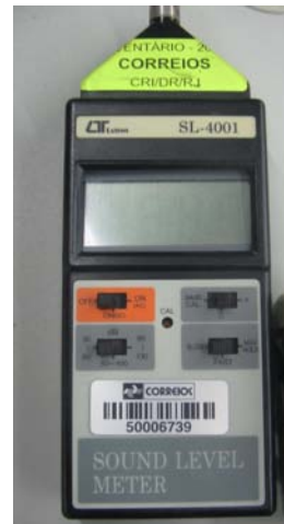
Decibélimetro: Lutron modelo SL – 4001. Calibrado a 94 dB, na banda de 50 a 100Db. Curva A, Slow.
