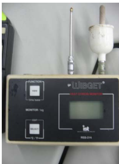
Termômetro (medidor de stress térmico): The Wibget – IST, RSS – 214.
