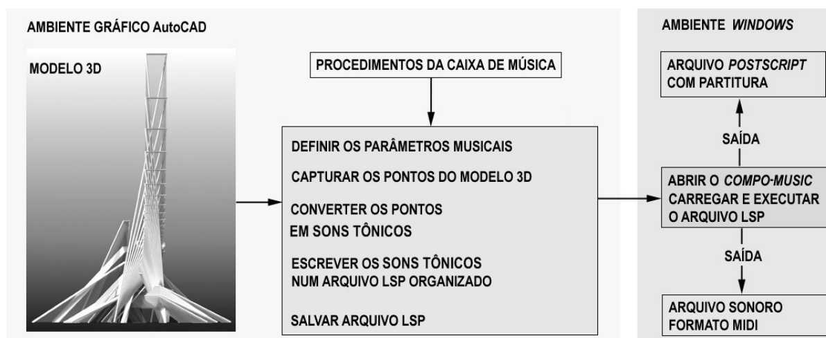
Figura 30) Esquema funcional da caixa de música. (Fonte: o autor).
