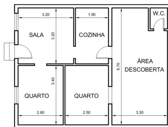
Fig.I.16 Planta típica da unidade. BACKHEUSER, 1906, p.92.
