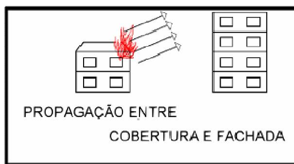
Ilustração 31: Propagação entre cobertura e fachada.
