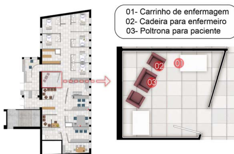
FIGURA 92 – Planta estudo de viabilidade do ambiente de coleta de sangue
