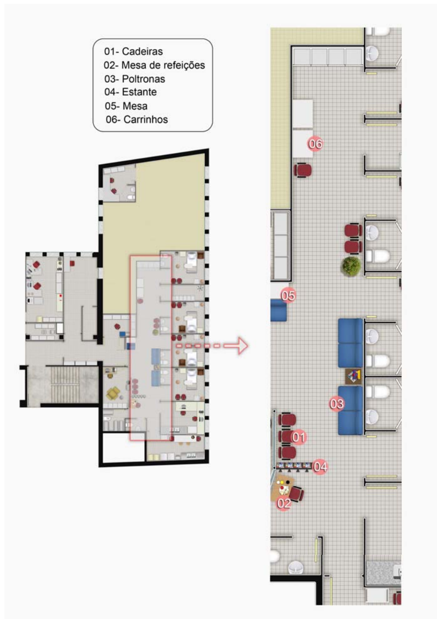
FIGURA 56 – Plantas de implantação e configuração da sala de espera – anterior ao projeto 102 Fonte: Levantamento realizado pela autora em 1º de abril de 2008.
