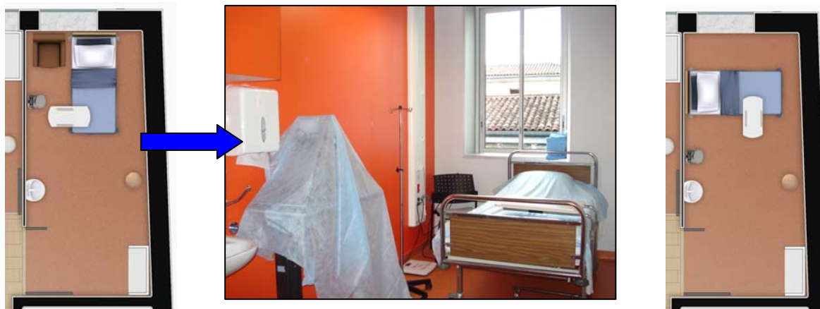
FIGURA 129 – Planta e foto do leiaute proposto pelo projeto (à esquerda e no meio) e planta da alteração do leiaute realizada pelos funcionários (à direita)
