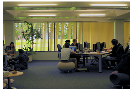
Fig. 2.30 – sala de estudos – uso de material absorvente sobre a janela, no piso, no teto e em parte do mobiliário.
