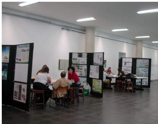
Fig. 2.32 – Espaço “cafauzão” sem tratamento acústico: pouca absorção, tempo de reverberação elevado. Dificuldade de comunicação verbal e alto desconforto acústico.
