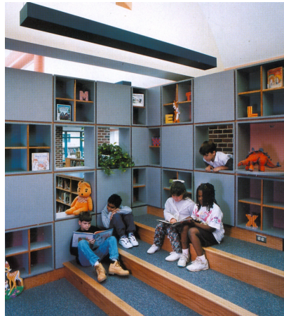
Fig. 2.37 – Canto da leitura, o uso de material absorvente no piso torna o local mais aconchegante e auxilia no controle da reverberação
