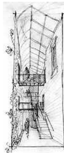
Figura 17: ilustração do átrio que conecta o edifício principal ao seu anexo provendo-os de iluminação natural. Fonte: Centre for Indigenous Environmental Resources, cortesia de Corbett Cibinel Architects.
