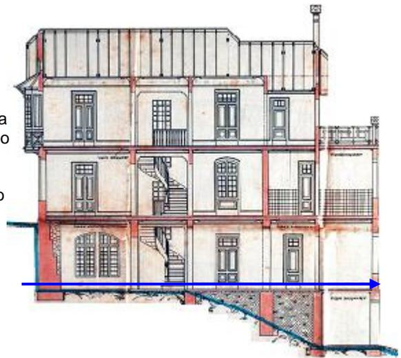
Fig. 119: Corte longitudinal que mostra a declividade do terreno e o patamar que sofreu aterros e desaterros e sobre o qual foi edificada a casa..
