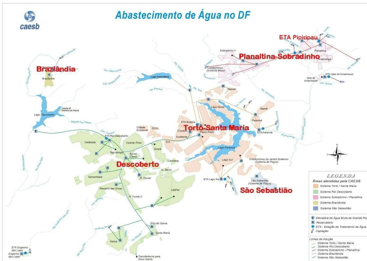
Figura 65 – Sistema de abastecimento de água da região.
