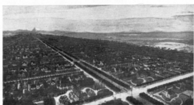
Fig. 2. Vista aérea de la ciudad lineal con zonas verdes como límite añadidas a ambos lados de ella. Un bulevar de 40 m de ancho, filas de árboles y doble pista para vehículos, constituyen el eje principal. Con intervalos de 500 m aparecen calles transversales de 20 m, formando «supermanzanas» de 40.000 a 60.000 m², 1926.
