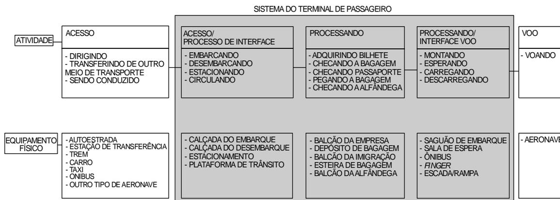
Figura 39: Os componentes do sistema do terminal de passageiros
