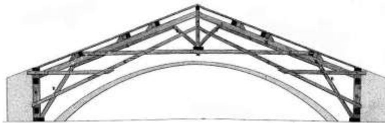
Figura 398: Estrutura de telhado cobrindo abóbada, 1805.
