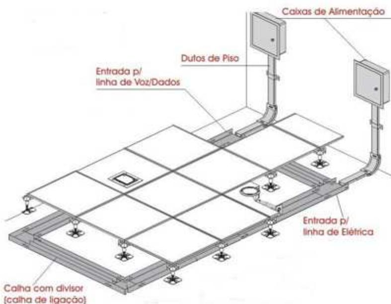
**Figura 14:** Piso elevado demonstrando montagem e passagem de cabeamento.
