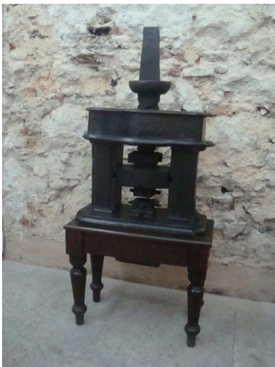
Figura 7: Prensa de cunhar moedas em ferro fundido.
