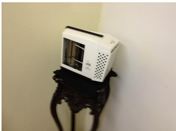
Figura 36 – Termo-higrômetros para monitoração dos índices de conforto ambiental na Reserva Técnica do MR
